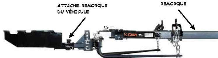
Les barres de torsions améliorent le contrôle du véhicule et de la remorque en répartissant également la charge entre les deux véhicules. De cette façon, la remorque et le véhicule seront de niveau et ça allègera le poids sur la suspension et la carrosserie du véhicule.
